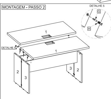
NA SEQUENCIA PARA FACILITAR A FIXAÇÃO DO TAMPO (1), COM A ESTRUTURA EM PÉ, FAÇA O ENCAIXE DO TAMPO (1) NOS PÉS LATERIAS (3,2) CONFORME INDICA DETALHE 5.
