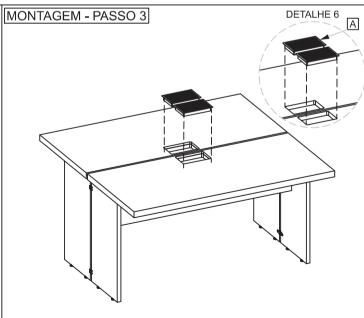
PARA FINALIZAR A MONTAGEM, FAÇA O ENCAIXE DA CAIXA DE INSPEÇÃO (A) CONFORME INDICA O DETALHE 6.
